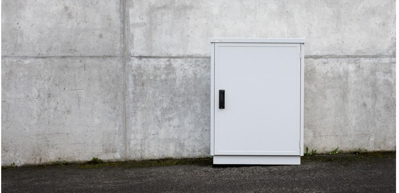
**Die Aluminium-Verteilkabine Typ AVK besteht aus einem stabilen und verwindungsfreien Grundgerüst aus Aluminium-Strangpressprofilen und bietet mit den doppelwandigen Wandelementen unendlich viele Möglichkeiten. Es können sowohl in der Breite, Höhe wie auch in der Tiefe alle Dimensionen in 1 mm Abstufungen hergestellt werden.**
